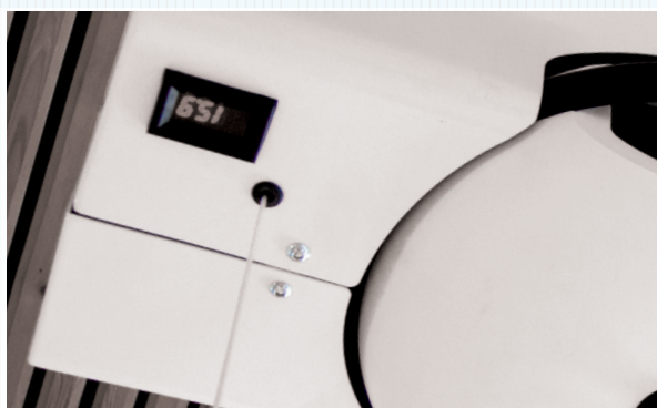
La descarga de peso se puede ajustar individualmente en el mando manual: 0-85 kg.
